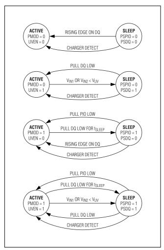
Figure 1. Sleep-Mode State Diagram for DS2775/DS2776
